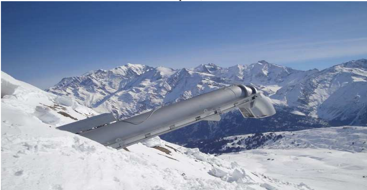
Рис 4. Система Gazex для принудительного схода лавин
